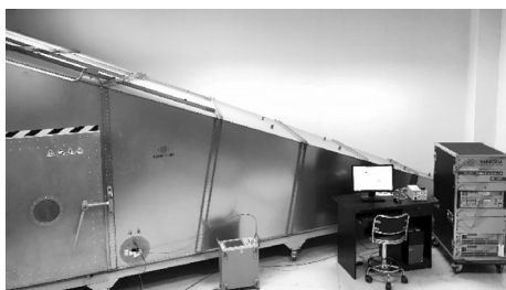
图7 GTEM小室实验平台
